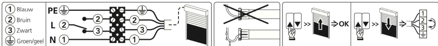
⚠ - Mogelijkheid om **3 parallele max.** motoren op een schakelaar te kabelen.
