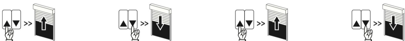
⚠ Il est conseillé d'effectuer ces deux cycles ouverture/fermeture dès l'installation du produit.
