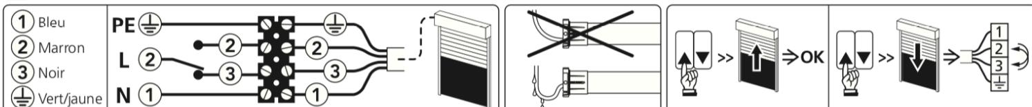
⚠ Possibilité de câbler **3 moteurs max.** en parallèle sur un interrupteur.
