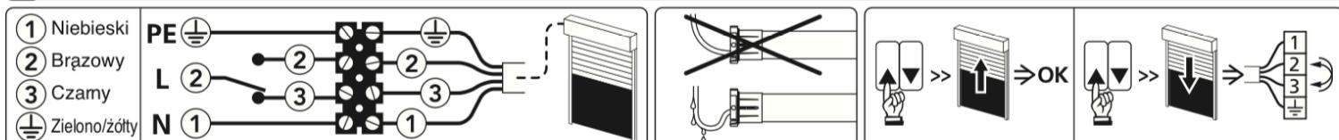
⚠ - Równolegle można podłączyć maksymalnie 3 napędy do jednego przełącznika.
