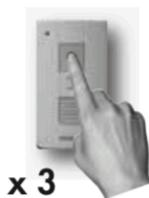
Bringen Sie den Rollladen in den oberen Anschlag (Einlauftrichter). Drücken Sie 3 x in 3 Sekunden am Hauptsender auf "oben".
