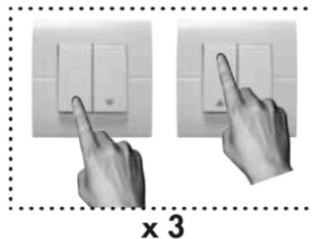
Bringen Sie den Rollladen in den oberen Anschlag (Einlaufrichter). Drücken Sie auf "oben" und "stop" 3 x innerhalb 3 Sekunden am Hauptsender .
