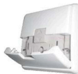
Clipper les 2 touches de la commande
